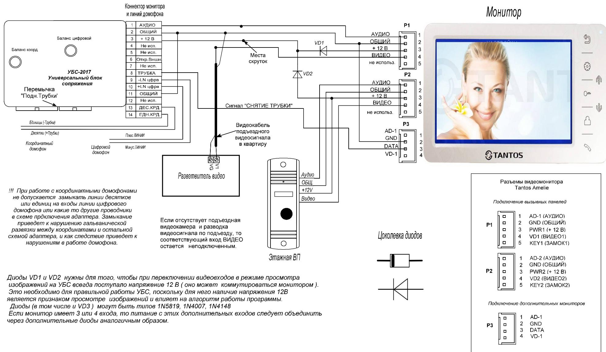
!!! При работе с координатными домофонами не допускается замыкать линии десятков или единиц на входах линии цифрового домофона или какие то другие проводники в схеме присоединения адаптера. Замыкание приведет к нарушению гальванической развязки между координатами и остальной схемой адаптера, и как следствие приведет к нарушениям в работе домофона.
